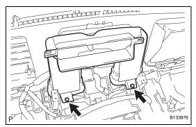
7. INSTALL NO. 3 HEATER TO REGISTER DUCT
